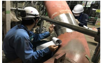
蒸気配管の非破壊検査 高温高圧の配管は厳密な検査を行い、国基準に適合したもののみ使用します。
