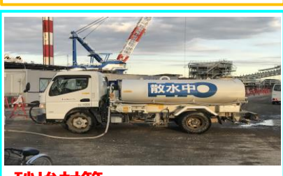
砂埃対策 散水を継続し、車両通行時の砂ぼこりを発生させないようにしています。
